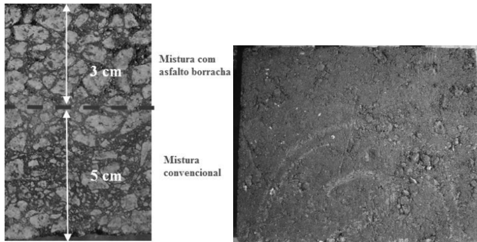
Figura 2: Configuração dos corpos-de-prova de misturas com asfalto borracha (a) espessuras (b) no sentido do ensaio
